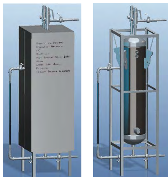
Figura 2 – Modelamento em 3D da caldeira, com e sem a cobertura de isolamento térmico.
